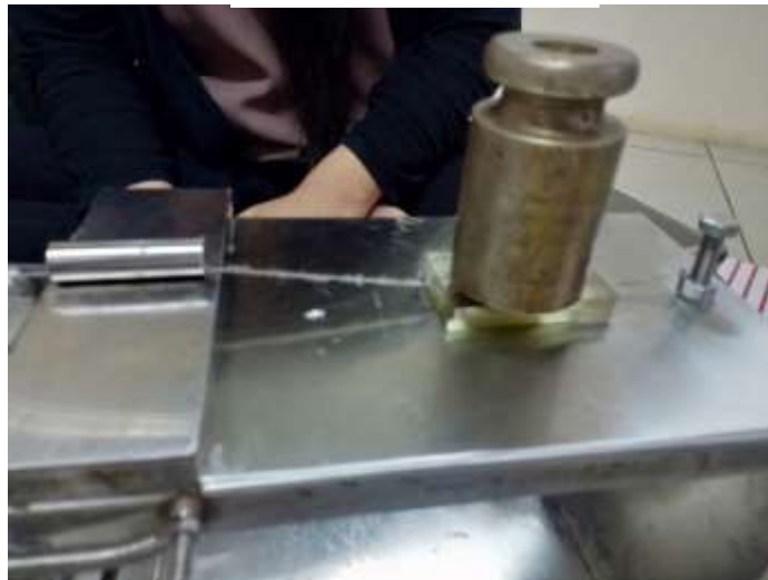
Gambar uji daya lekat
