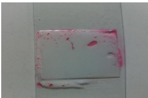
Pengujian kelarutan zat warna losion pelembab dengan larutan sudan III
