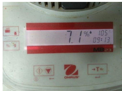
Lampiran 6. Gambar hasil identifikasi kadar air pada serbuk daun singkong sebanyak 3 kali replikasi dengan alat Moisture balance
