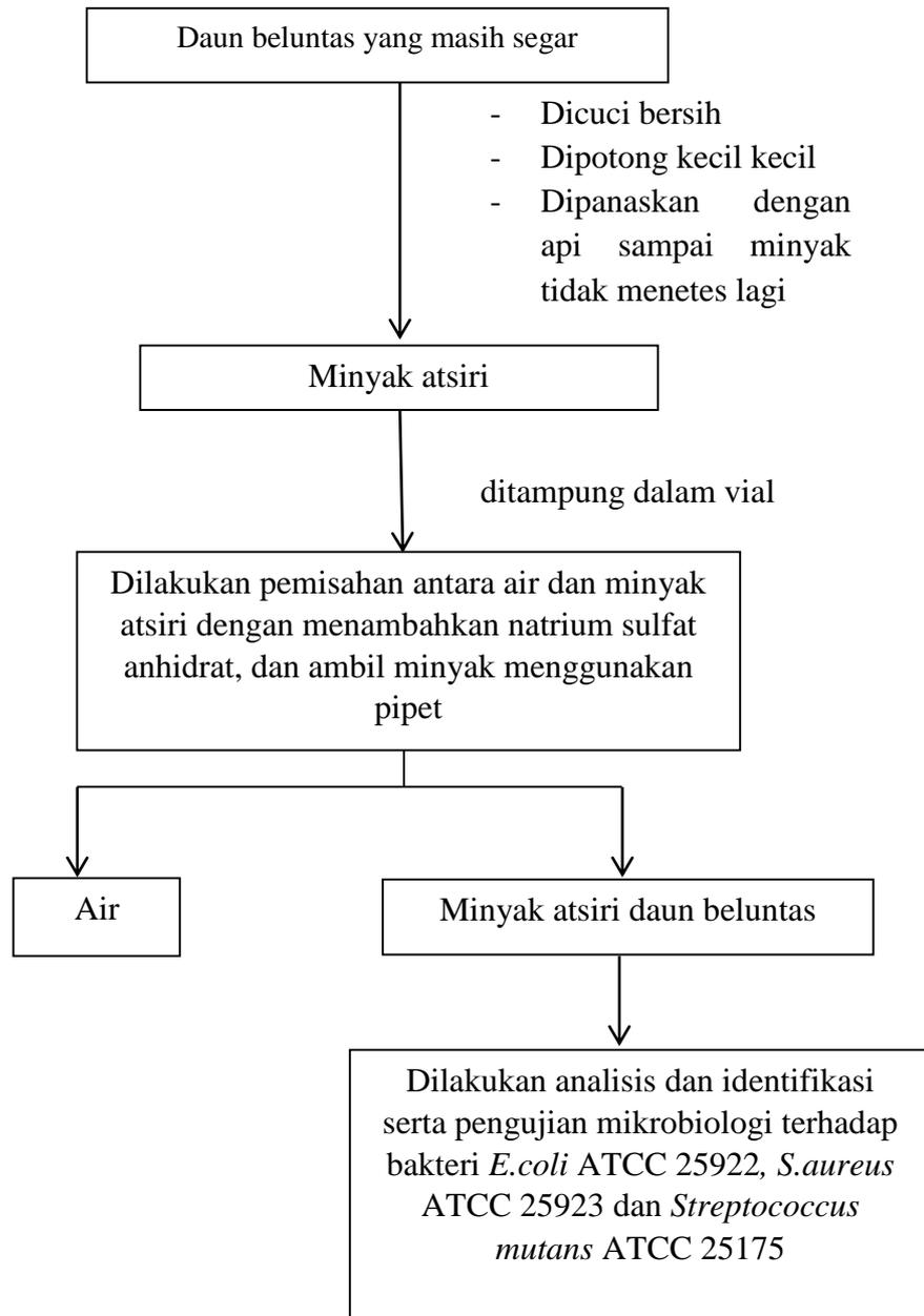
Gambar 5. Skema isolasi minyak atsiri daun beluntas
