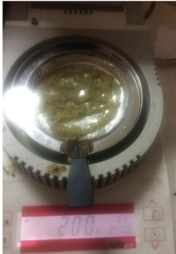
Penetapan susut pengeringan serbuk dengan Moisture Balance
