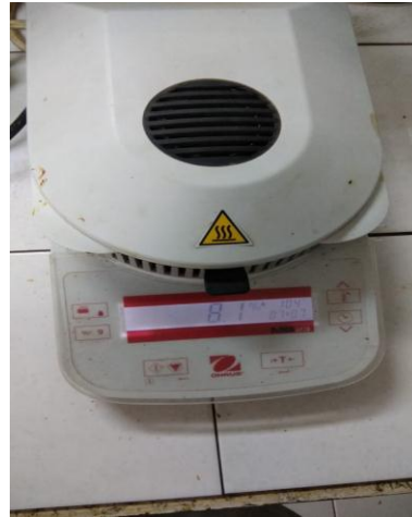
Penetapan susut pengeringan serbuk dengan Moisture Balance
