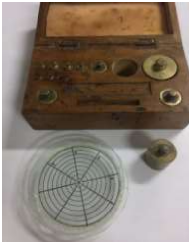
Uji daya sebar
