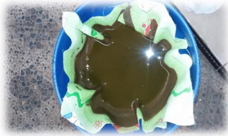
Penyaringan dengan kain flanel
