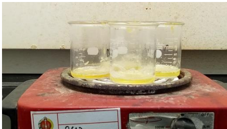
Gambar 3. Proses Destruksi Sampel
