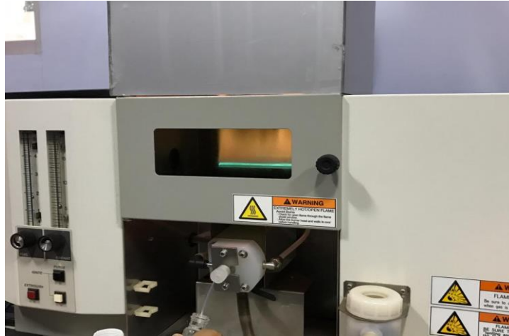
Gambar alat spektrofotometer Serapan Atom merk Shimadzu AA-6200
