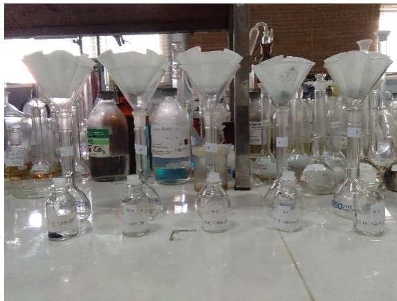
Gambar 7. Sampel dilarutkan dengan pelarut aqua regia
