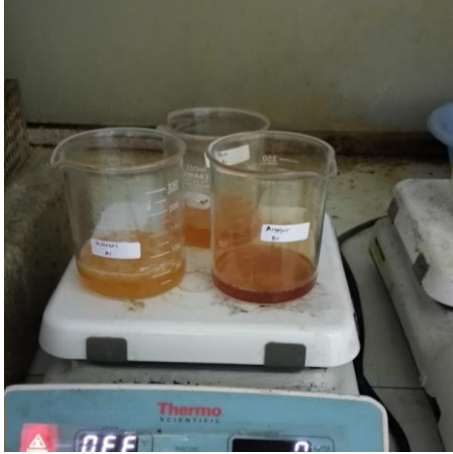
Gambar 9. Sampel destruksi basah dengan \text{HNO}_3
