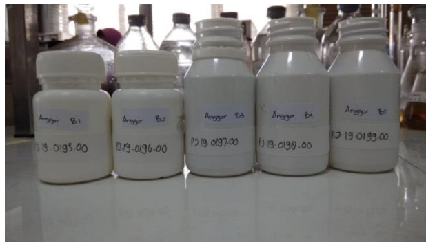
Gambar 11. Sampel siap dianalisis dengan SSA
