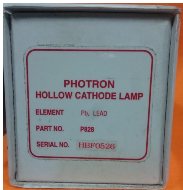
Gambar 13. Model lampu katoda yang digunakan
