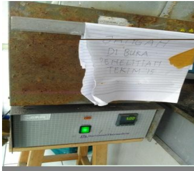
Destruksi dengan muffle 500 °C
