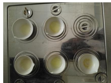
Proses pengeringan dengan waterbath
