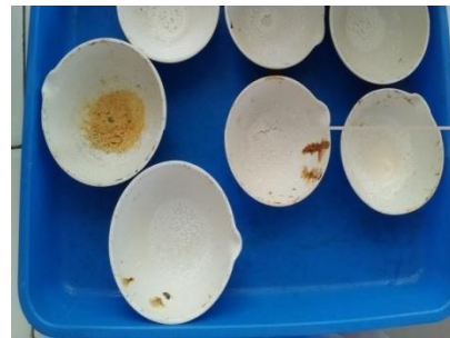
Sampel saat keluar dari muffle
