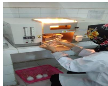
Inject sampel dengan SSA
