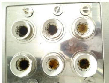
Pengeringan di waterbath setelah ditambah \text{HNO}_3 pekat
