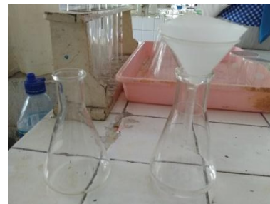
Proses penyaringan dengan kertas whattman no 42
