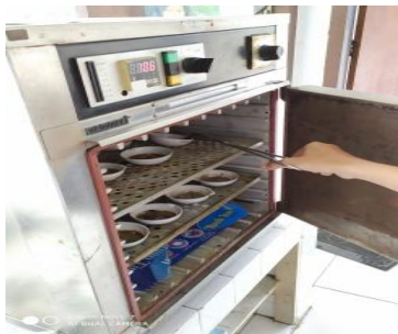
Pemindahan sampel dari oven ke desikator
