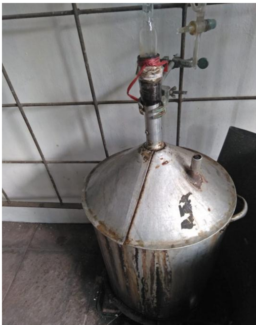
Alat destilasi uap dan air
