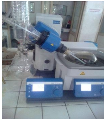
Penguapan atau pemanasan didalam rotary evaporator
