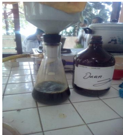
Penyaringan hasil rendaman ekstrak menggunakan etanol 70%
