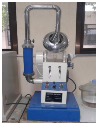
Gambar 1. Alat Pan Coating Sumber : koleksi pribadi
