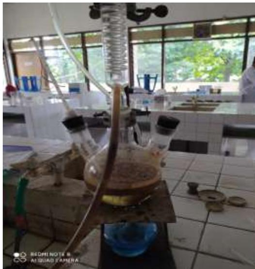
Gambar 2. Pembuatan Selulosa asetat ( pretreatment)
