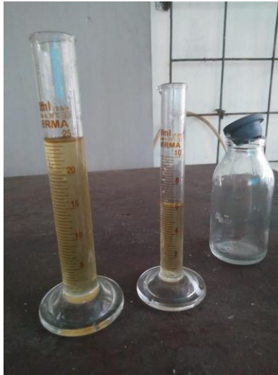
Pengukuran minyak atsiri dengan gelas ukur
