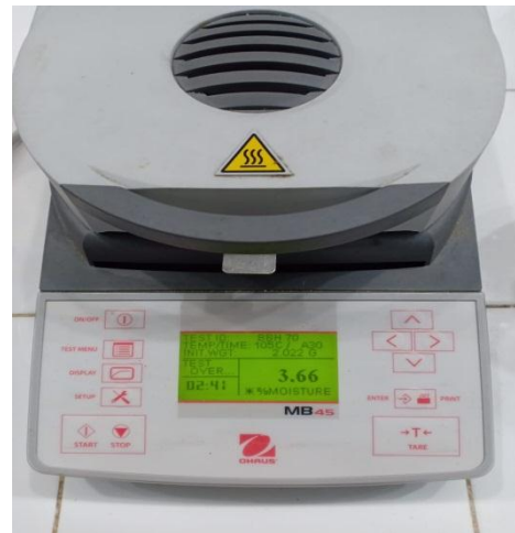
Penetapan susut pengeringan serbuk dengan moisture balance
