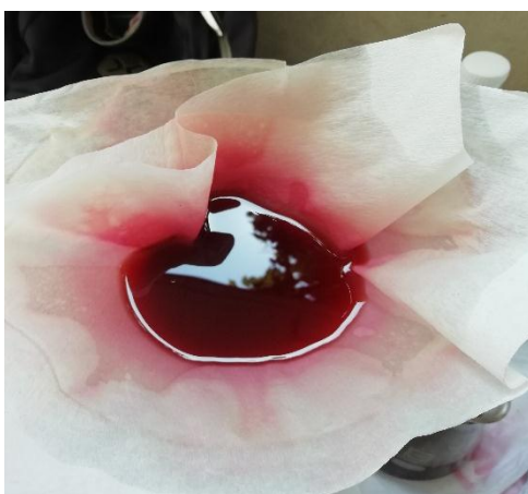
Penyaringan ekstrak dengan kertas saring
