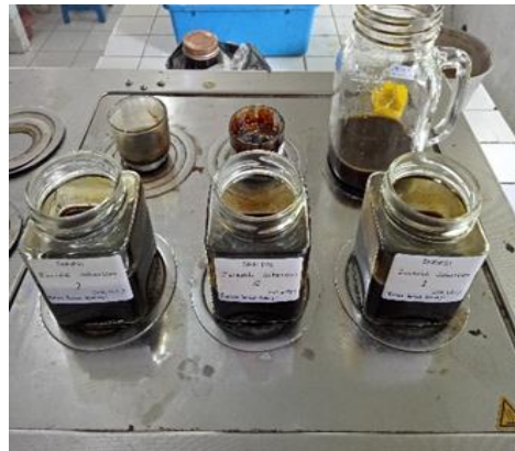
Pengentalan ekstrak dengan oven ( 95°C )
