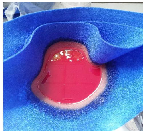
penyaringan ekstrak dengan kain flanel
