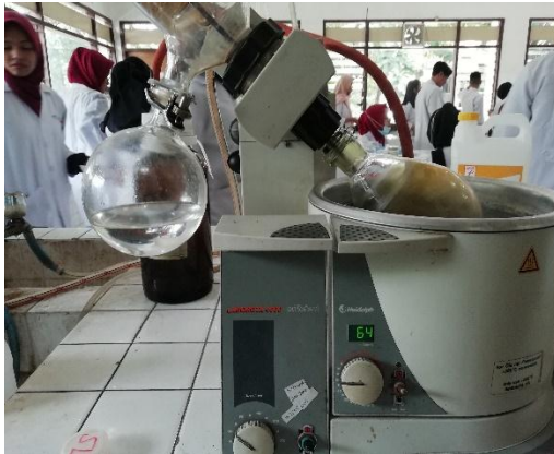
Penguapan ekstrak dengan Vacuum Rotary Evaporator
