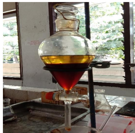
Fraksinasi menggunakan pelarut etil asetat dan air
