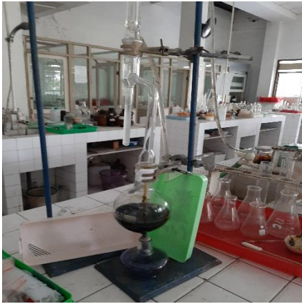
Penetapan kadar air dengan rangkaian alat Sterling-Bidwell
