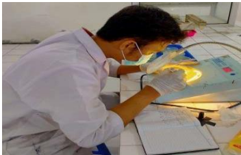
Gambar 7. Proses Menghitung Koloni pada Uji ALT
