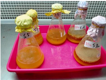
Gambar 16. Buffer Pepton Setelah Inkubasi 24 jam
