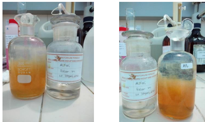
Gambar 5. Sampel setelah ditambahkan larutan \text{MnSO}_4 dan larutan Alkali iodide azida.
