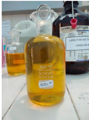
Gambar 6. Sampel setelah penambahan Asam Sulfat.
