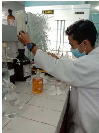
Gambar 7. Proses titrasi sampel.
