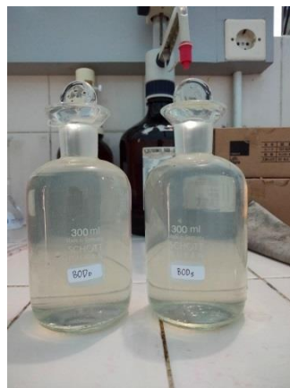
Gambar 4. Sampel sebelum ditambahkan larutan \text{MnSO}_4 dan larutan Alkali iodide azida.
