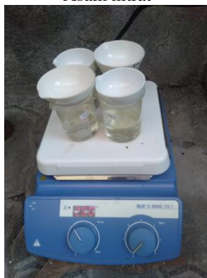
Proses destruksi dengan alat hotplate
