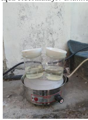
Proses destruksi dengan alat hotplate
