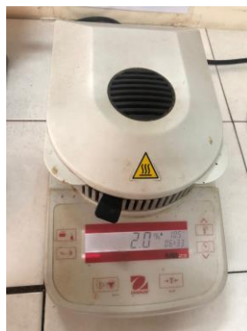
Kadar lembab ekstrak dengan alat moisture balance
