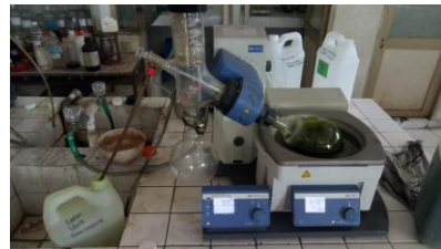
Proses pemekatan dengan rotary evaporator
