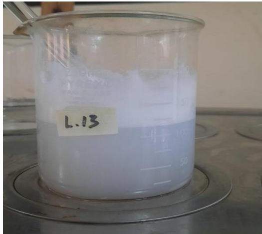
Proses pembuatan sabun cair cuci tangan dengan metode pemanasan
