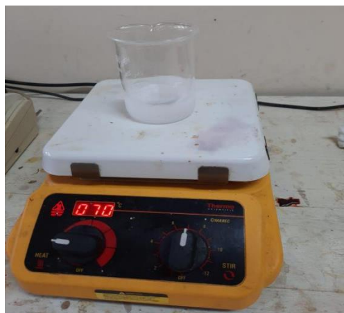
Proses pembuatan sediaan sabun cair cuci tangan dengan metode alat Stirrer
