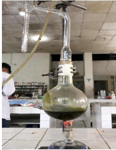
Destilasi ( alat untuk mengukur kadar air)
