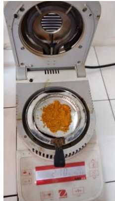
Penimbangan uji susut pengeringan
