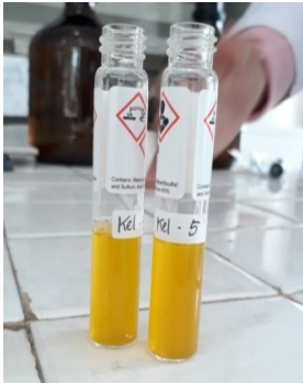
Gambar 26 Campuran sampel dan K_2Cr_2O_7 dalam tube
