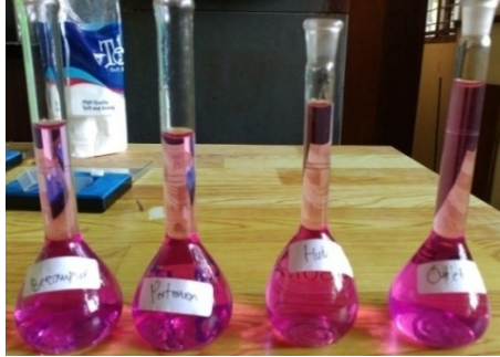
Gambar 38. sampel yang telah ditambah sarutan sulfanilamida dan NED Dihidrochlorida
