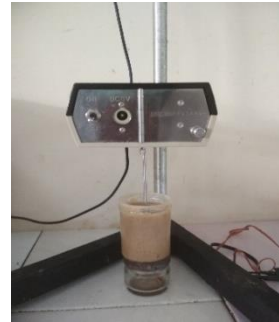
Proses pengujian viskositas dengan rotor nomor 2
