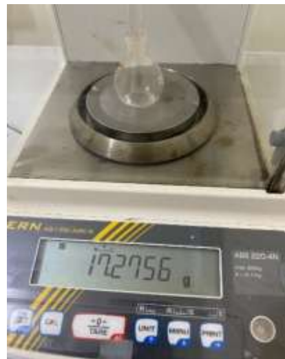
Timbangan analitik dan piknometer
