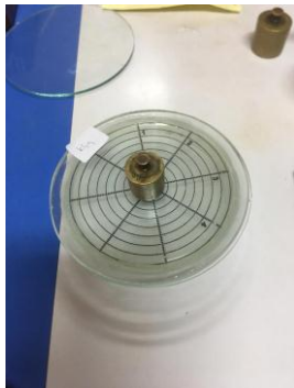
Uji daya sebar
