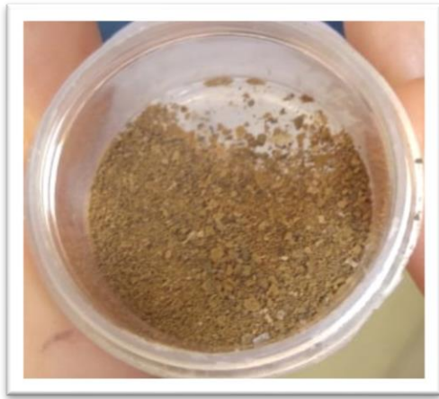
Gambar 3 Hasil sintesis nanokomposit ZnO/SiO 2 dari abu vulkanik dan limbah seng
