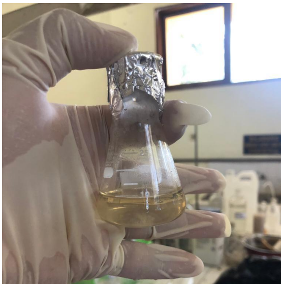
Hasil preparasi Sampel dalam 10 ml dan siap di uji pada Alat Spektrofotometer Serapan Atom (SSA)
