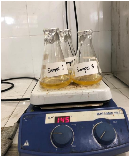
Proses Pemanasan dengan Hotplate suhu 145^{\circ}\text{C} setelah penambahan \text{HNO}_3 pekat
