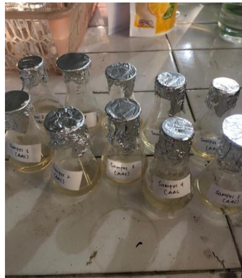
Hasil preparasi Sampel dalam 10 ml dan siap di uji pada Alat Spektrofotometer Serapan Atom (SSA)
