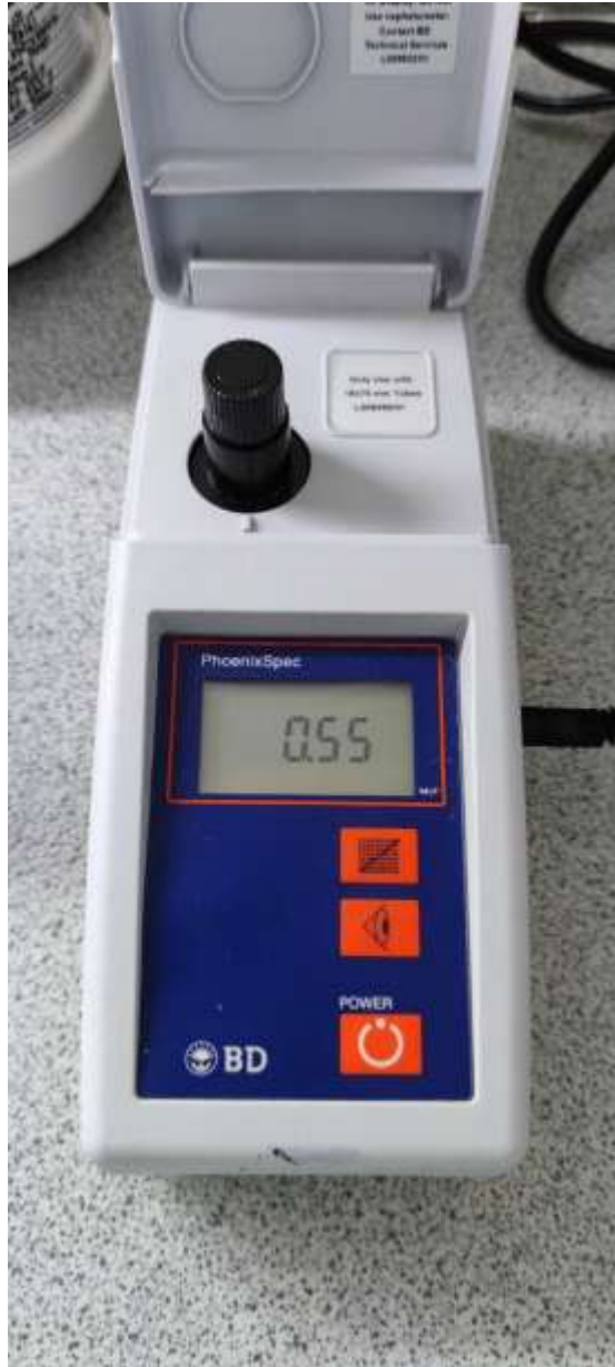
Gambar 8. BD PhoenixSpec Nephelometer untuk pembacaan kekeruhan suspensi (Sumber: dokumen pribadi)
