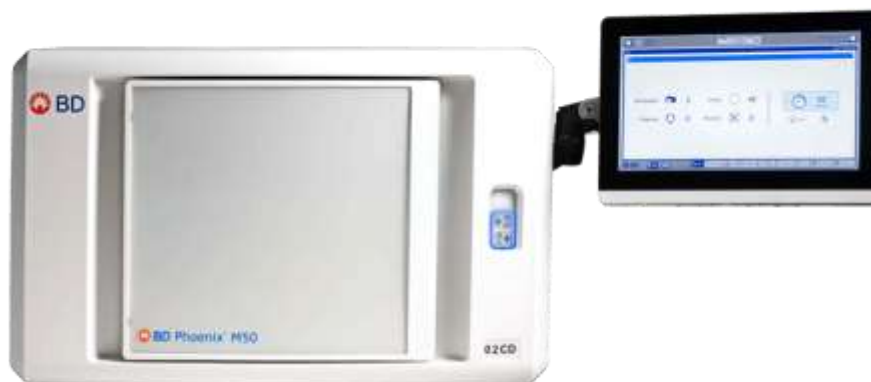
Gambar 7. BD Phoenix instrumen uji identifikasi dan uji sensitifitas antimikroba otomatis (Sumber: www.bd.com )
