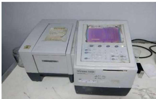
**Gambar 1. Foto alat Spektrofotometer UV-Vis**
