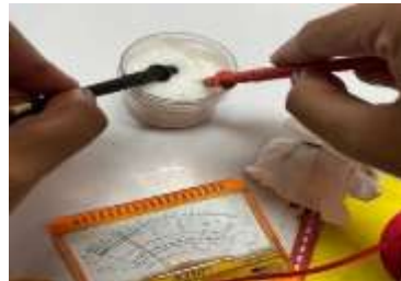
Uji tipe emulsi M/A dengan elektroda
