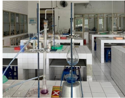
Gambar 33. Tahap Destilasi Metode Kjeldahl
