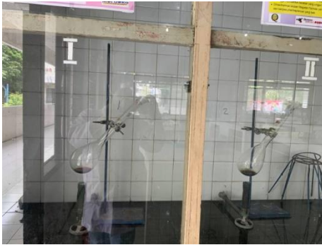
Gambar 32. Tahap Destruksi Metode Kjeldahl
