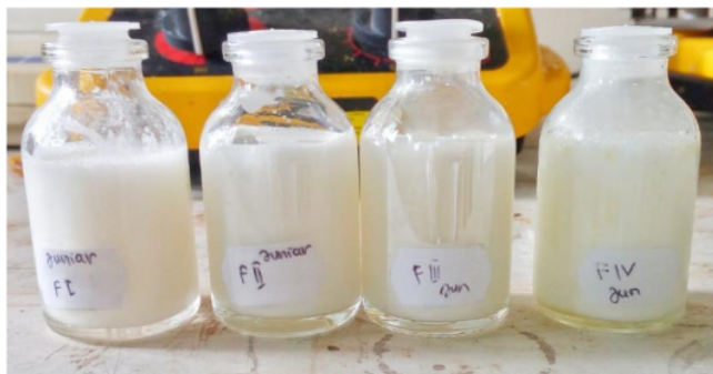
Gambar 1. Transfersom naringenin yang terbentuk berdasarkan perbedaan rasio molar fosfolipid dan surfaktan. F1 (92,5:7,5), FII (90:10); FIII (85:15), dan FIV (80:20).
