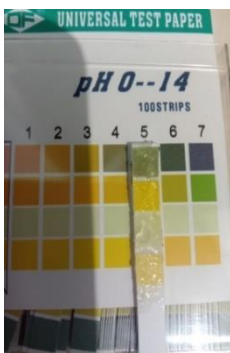
Uji pH dengan universal test paper
