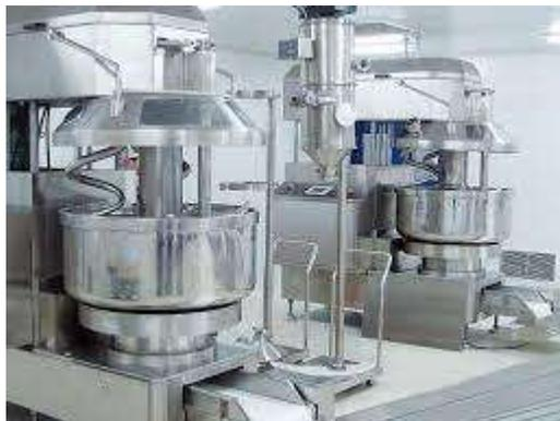
Produk yang ada didalam tangki akan dicampurkan dengan produk berupa cairan, baik larutan, suspensi/ emulsi dengan pusing motor letak ditengah maka akan membentuk satu putaran untuk mencampurkan bahan sampai homogen
