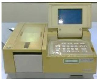
Gambar alat spektrofotometer
