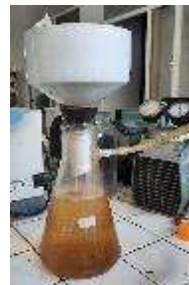
Penyaringan memakai corong bouchner
