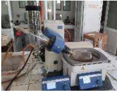
Proses pemekatan ekstrak menggunakan rotary evaporator
