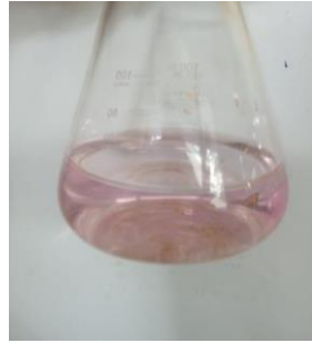
Hasil titrasi larutan primer \text{H}_2\text{C}_2\text{O}_4 \cdot 2\text{H}_2\text{O} 0,1 N dengan larutan standar sekunder \text{KMnO}_4 0,1 N
