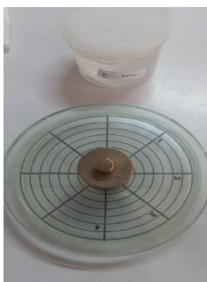
Uji daya sebar
