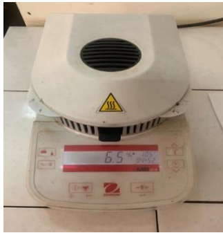
Uji susut pengeringan serbuk menggunakan moisture balance
