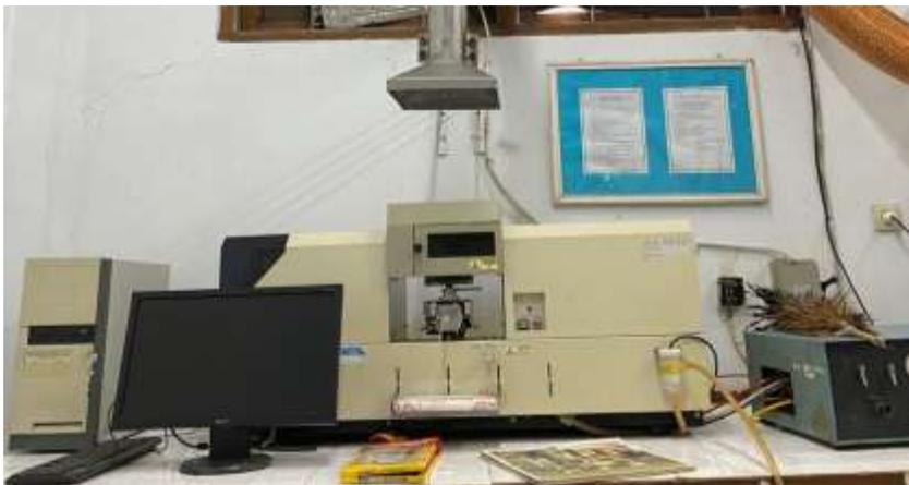
**Gambar 5. Spektrofotometri Serapan Atom**
