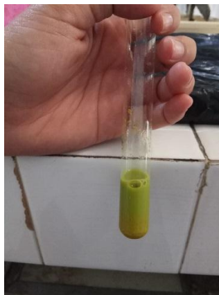
Uji kualitatif dengan pereaksi fehling A fehling B
