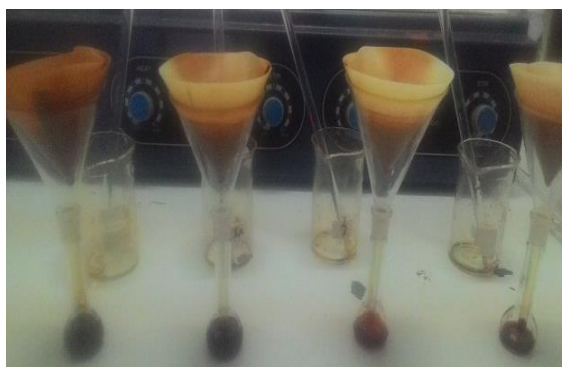
Gambar 14 Penyaringan hasil pelarutan residu penguapan dengan \text{HNO}_3 0,5 N
