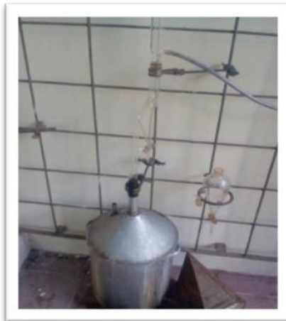
Rangkain Alat Destilasi Uap Air
