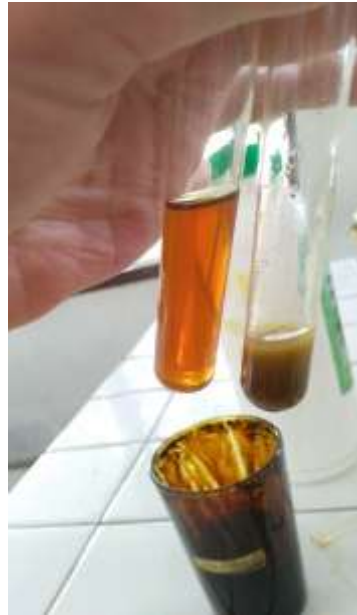
b. Filtrat ekstrak + \text{NaOH} 10%
