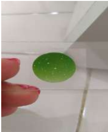
f. Uji tipe krim dengan methylene blue
