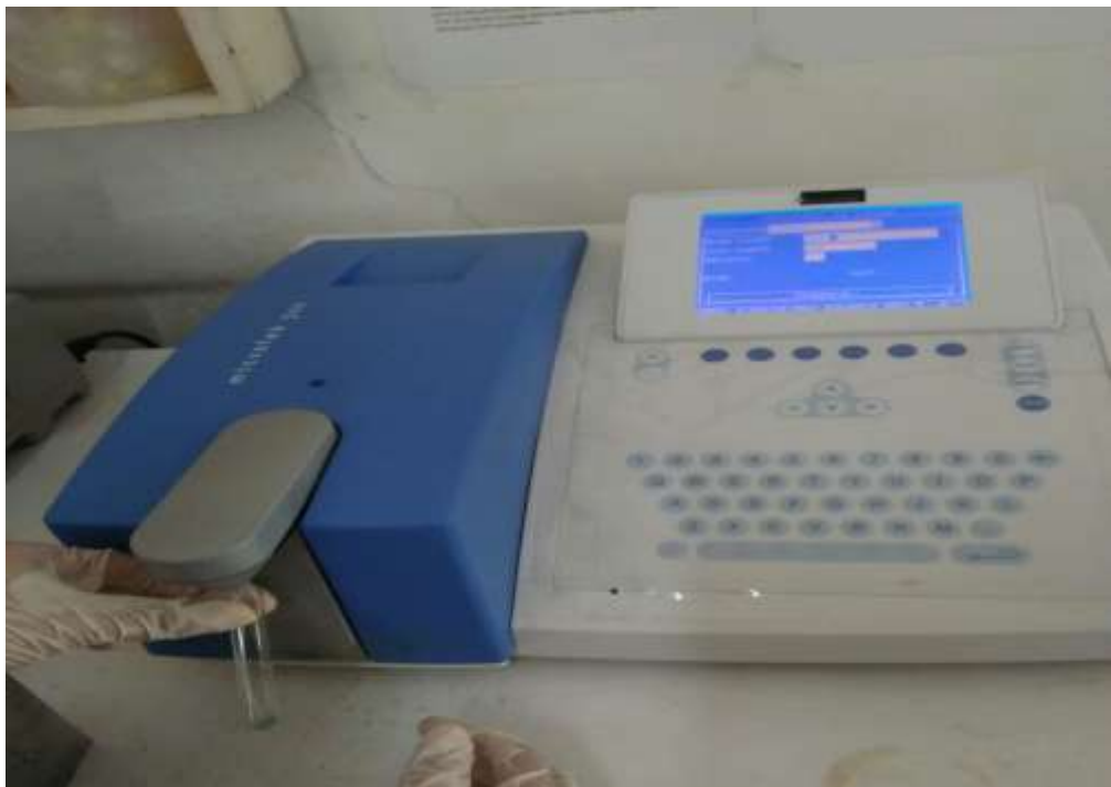
Pembacaan Sampel Kadar Albumin Serum dengan Alat Fotometr
